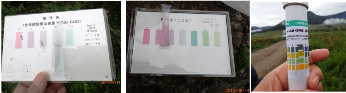
写真 26 St. 3 (左) 低濃度用パケットテストで COD8 以上を示し、(中)高濃度用パケットテストは 5 と 10 の間であったので、この地点の COD は 8 とした。(右) pH は 5 を示した。
