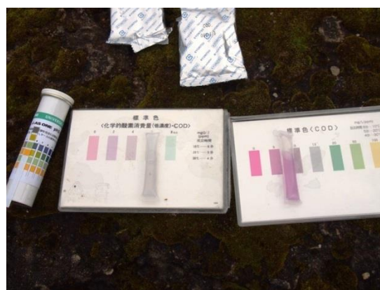
写真 6-2 St. 2 パックテスト (低濃度用) で 6mg/L、パックテストで 5~10mg/L を示した。
