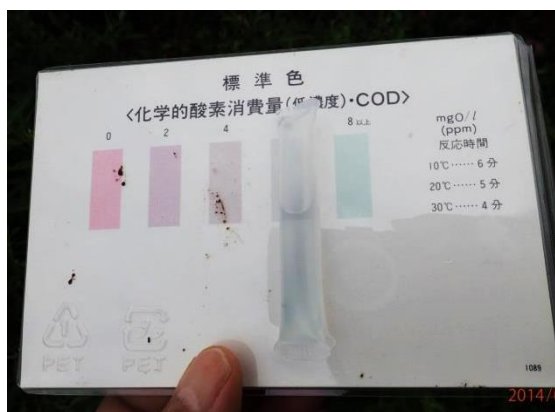
写真 6-1 St. 1 パックテスト (低濃度用) で 8mg/L 以上、パックテストで 8mg/L を示した。
