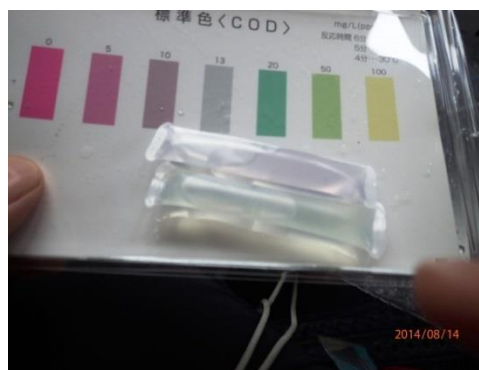
CODパケットテスト。10 mg/Lを示したので、念のためもう1回行ったが、同じであった。画像の色が違うのは、先に測定したほうが反応が進んでいく。
